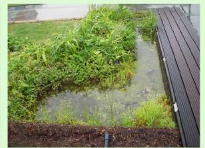
雨水池がメインの緑化の一例です。 木箱部分が雨水貯留タンクになっており、 タンクと池の相互送水設備が付いています。
